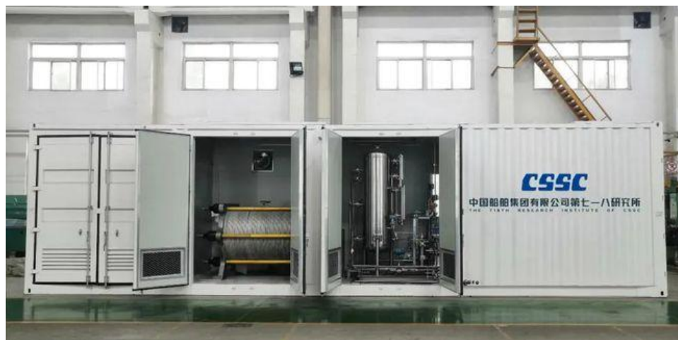
コンテナ式水素製造設備
