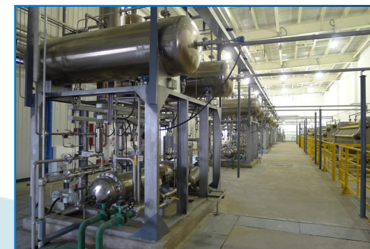
1Nm 3 /h ~ 1500Nm 3 /h まで対応 室内設置水素製造
