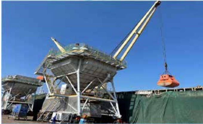
ペレット燃料荷卸し作業中
