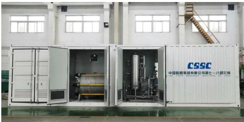
コンテナ式水素製造設備
